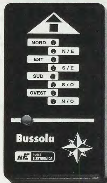
Fig.1 In questa bussola elettronica si accende il diodo led del punto cardinale verso cui è diretta la “freccia”. Se vedrete accendersi il diodo led S/E saprete che in quella direzione c'è il Sud/Est.
