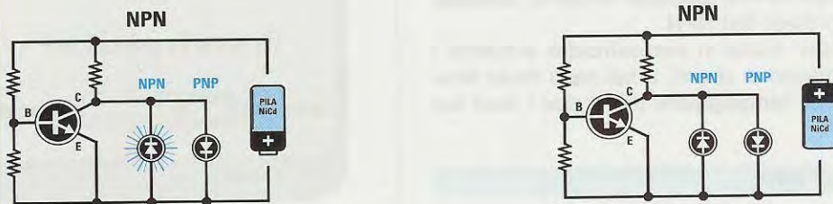
Fig.2 Quando il transistor NPN viene polarizzato con una tensione inversa, cioè con il "negativo" rivolto verso il Collettore, si accenderà il diodo led NPN. Quando viene polarizzato in modo corretto, cioè con il "positivo" rivolto verso il Collettore, i due diodi led rimarranno spenti. Se il transistor è difettoso lampeggeranno entrambi i diodi led.
