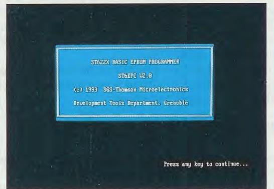
Fig.16 Dopo aver assemblato il programma prescelto (vedi fig.15) pigiate ALT+T poi la lettera P. Quando apparirà questa finestra dovrete premere un tasto qualsiasi.
